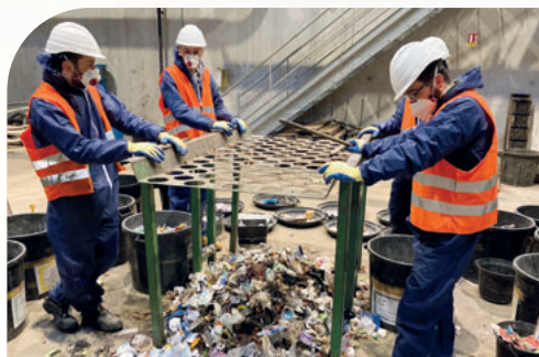
Campagne de caractérisation des ordures ménagères résiduelles : L'échantillonnage de 500 kg est répartie en 12 catégories de déchets puis en 24 sous-catégories. Elles sont toutes pesées puis enregistrées.
